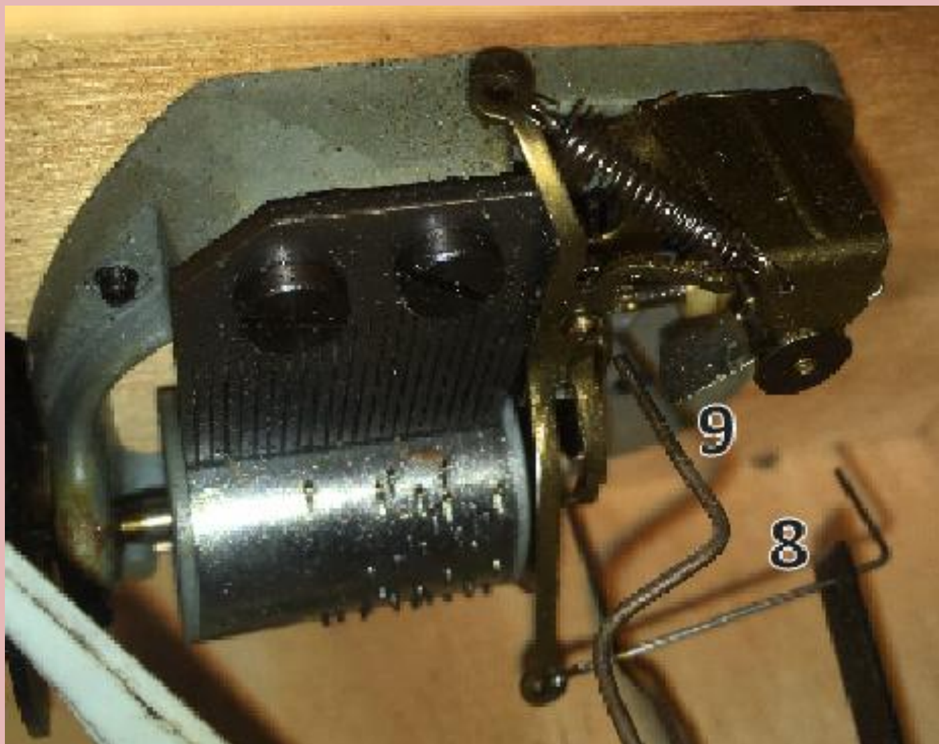
8= comando che sgancia la molla del carillon, 9= asta che impedisce la partenza del carillon prima della fine del canto del cuculo
