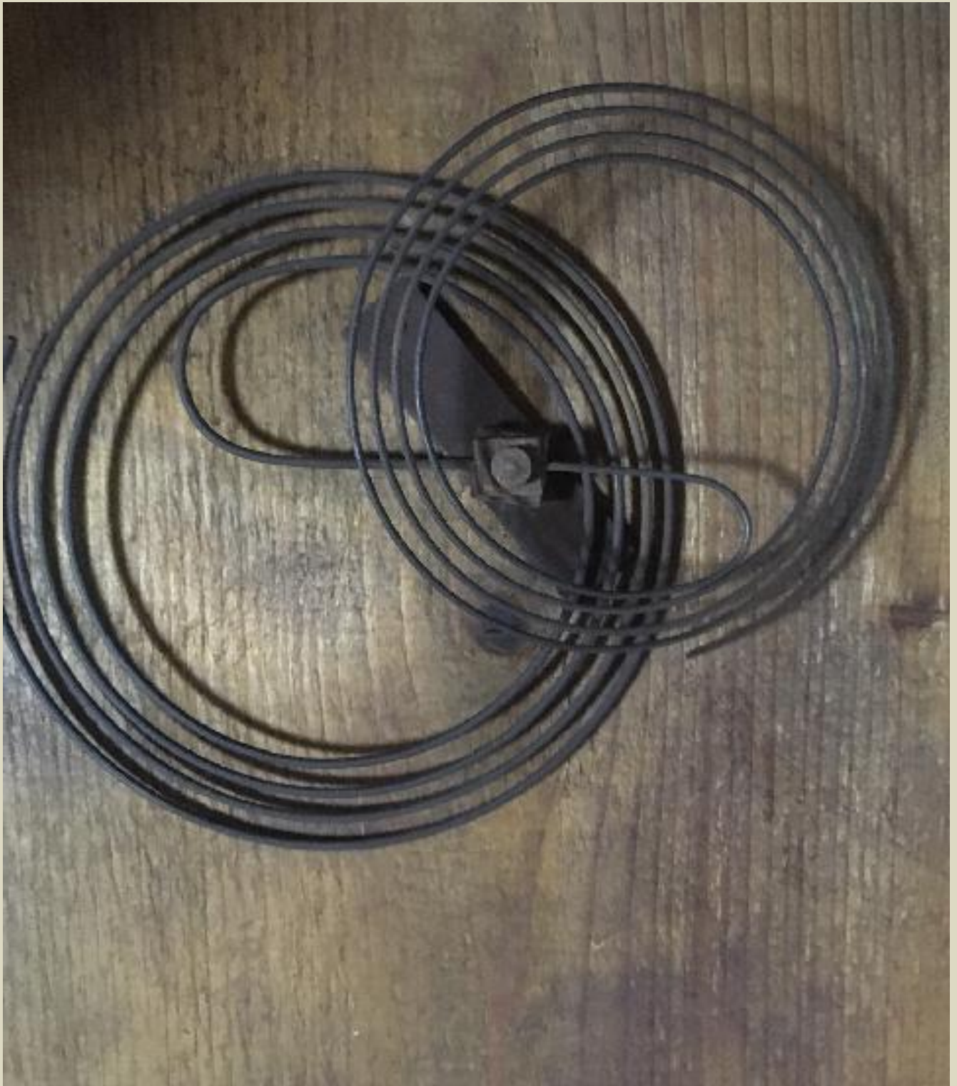
Le due spirali: la piccola per la quaglia la grande per il cucù
